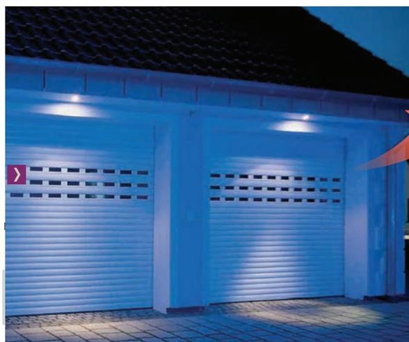
Lames horizontales largeur 75mm à double paroi injectées de mousse de polyuréthane isolante à haute densité.
